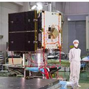
で、エンジンや機体などの構造は、はやぶさと同じ設計になっています。本体と側面に取り付ける太陽電池パネルは完成していますが、観測などに使う内部機器はまだ搭載していません。
