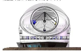
TMT の直径 30 メートルの主鏡はすばるなどの既存の望遠鏡の鏡のように 1 枚の鏡を一気に作ることが不可能な大きさであるため、492 枚の鏡を組み合わせることによって構成する設計になっています。合計で 574 枚の分割鏡のベースになる鏡材は日本が製作します。
