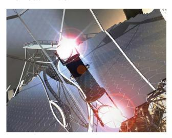
分割鏡は望遠鏡使用環境で熱膨張率がほとんど ゼロのガラスセラミックス材を使用し、1辺が72 センチメートルの六角形状です(上図)。今回製作 されたのはその素材となる直径 1.55 メートル、厚 さ 5.25 センチメートルの円形材料です。この鏡材 は今年度 60 枚分製作され、研磨による表面加工と 外形の加工が施されて、表面に金属膜をメッキして鏡として使用されます。
